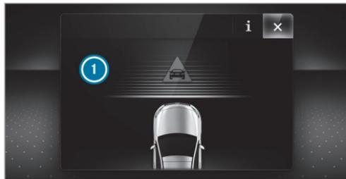
Lorsqu'un freinage autonome ou une assistance au freinage asservie à la situation a été déclenché, l'affichage ① apparaît sur l'écran multifonction, puis disparaît automatiquement après un court instant.
