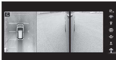
Lorsque la liaison électrique entre le véhicule et la remorque est établie, l'affichage passe à une vue de la caméra latérale.
