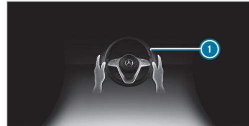
Si le système détecte que le conducteur ne dirige pas lui-même le véhicule ou qu'il lâche le volant pendant une période prolongée, l'affichage 1 apparaît. Si le conducteur ne dirige toujours pas activement le véhicule, un signal d'alerte retentit de façon répétée en plus de l'alerte optique.
