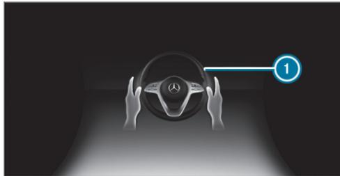
Si le système détecte que le conducteur ne dirige pas lui-même le véhicule ou qu'il lâche le volant pendant une période prolongée, l'affichage ① apparaît sur l'écran multifonction. Si le
