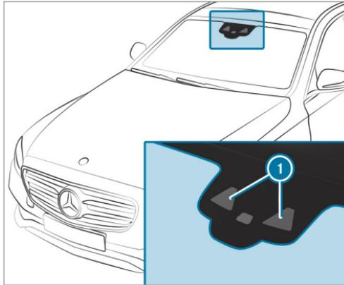
L'assistant de signalisation routière détecte les panneaux à l'aide d'une caméra multifonction ①. Il vous aide en affichant les limites de vitesse et interdictions de dépasser détectées sur le combiné d'instruments.
