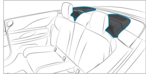
Les arceaux de sécurité se trouvent sous les caches situés derrière les appuie-tête arrière. Les arceaux de sécurité se déclenchent lorsqu'un risque de retournement du véhicule est détecté.
