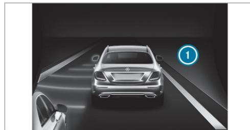
Lorsqu'une intervention de freinage permettant de corriger la trajectoire a lieu, le voyant rouge d'alerte intégré au rétroviseur extérieur clignote et un signal d'alerte retentit. En outre, un affichage (1) signalant un risque de collision latérale apparaît sur l'écran multifonction.
