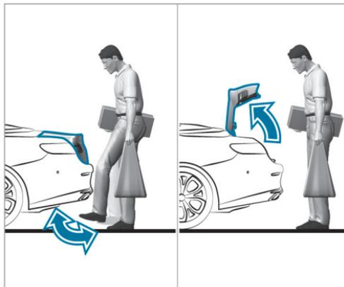
La fonction HANDS-FREE ACCESS vous permet d'ouvrir ou de stopper le couvercle de coffre d'un mouvement du pied sous le pare-chocs.
