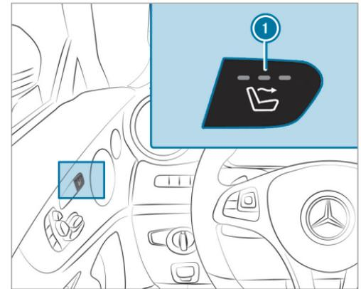
La fonction AIRSCARF permet d'envoyer de l'air chaud au niveau de la tête et de la nuque des occupants du véhicule. L'air chaud sort par les buses situées au niveau des appuie-tête.
