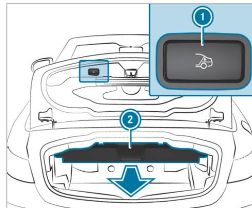
▶ **Véhicules équipés d'une séparation de coffre manuelle** : pour ouvrir la séparation de coffre ②, poussez-la dans le sens inverse de la flèche jusqu'à la position finale supérieure en la tenant par la poignée.
