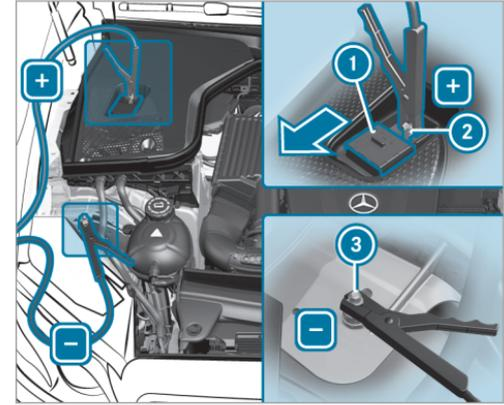
▶ Poussez le cache ① qui se trouve sur la borne positive ② du point d'aide au démarrage dans le sens de la flèche.
