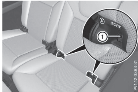
Etriers de fixation ISOFIX des sièges de la 3e rangée
