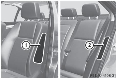
Les airbags latéraux avant ① et les airbags latéraux arrière ② se déploient au niveau des joues extérieures des sièges.
